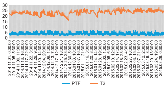
3. ábra. Az irodaépület teljesítményfelvételének és belső hőmérsékletének időbeli lefutása
